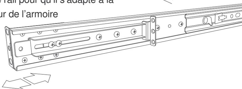
4. Installez le support avant et arrière sur l'armoire.
