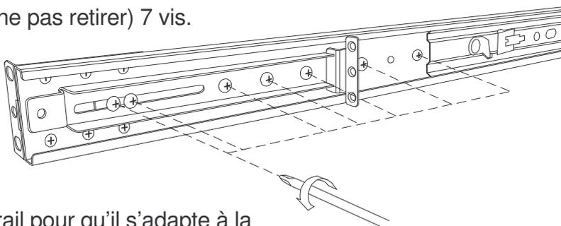
3. Ajustez le rail pour qu'il s'adapte à la profondeur de l'armoire
