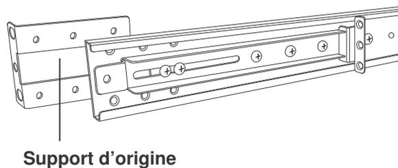
C4. Ajustez le rail et insérez l'extension de support à l'arrière du rail. A présent, ajustez le support pour qu'il s'adapte à votre armoire. Insérez 2 ou 3 vis (mais ne pas trop serrer) suivant la longueur désirée. Ne pas visser qu'une seule vis.
